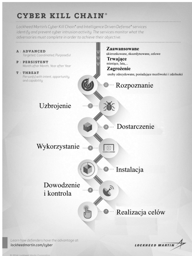
Rysunek 12. Fazy ataku cybernetycznego. Źródło: opracowanie własne na podstawie (Hutchins, et al., 2011).
